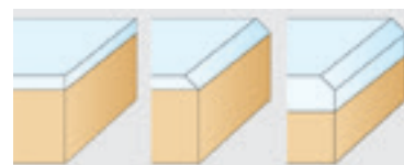
Szintbemarás Élletörés Szintbemarás + életörés
